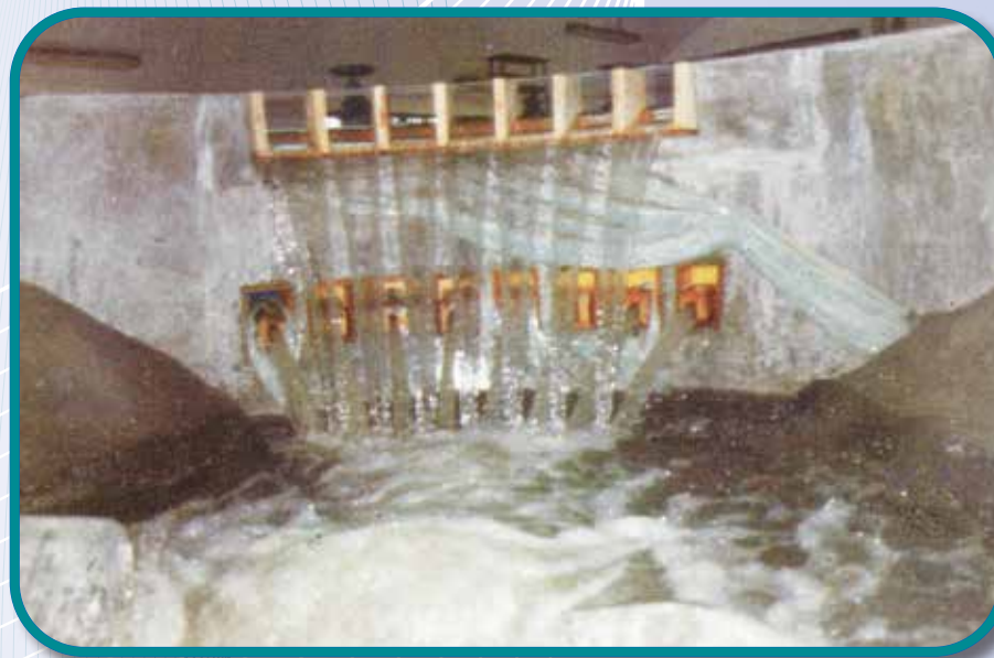
台大水工所主辦大壩溢洪道水工試驗
